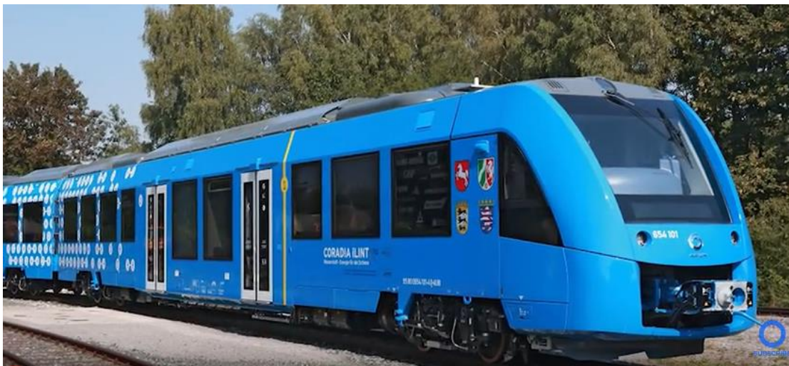
Figur 1. Vätgasdriven elektrisk motorvagn – kontaktledningen behövs inte längre. Ahlstrom Coradia iLint. 140 km/h. Fordonet är eldrivet och betydligt tystare än dieselmotorvagnar.
